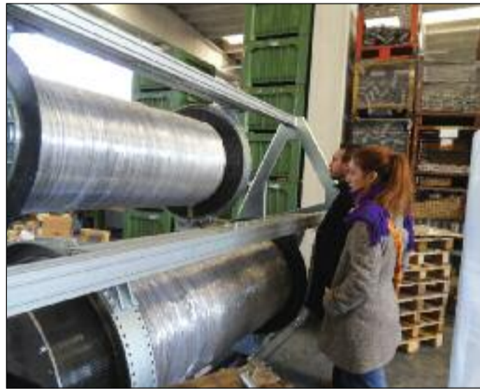
Le bobine su cui sono avvolti i 2500 metri di cavo che dall'aquilone porteranno il movimento agli alternatori. Ancora da montare, sono nei capannoni della Ro.Re a Sommariva Perno.
