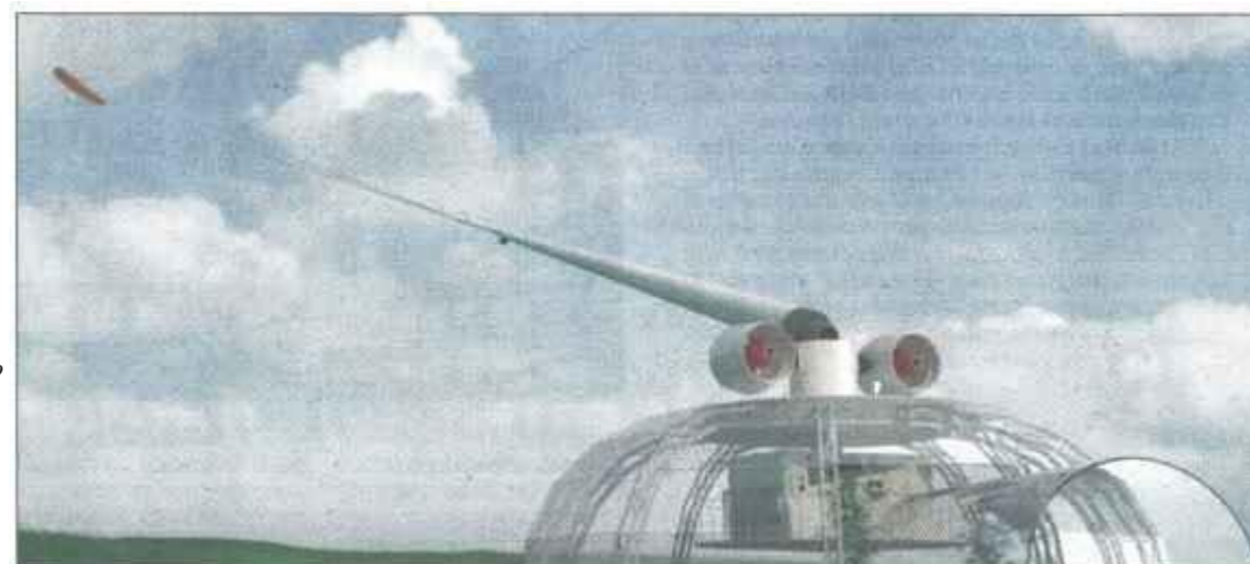
Una cupola custodirà le strumentazioni del Kite gen, che raccoglierà l'energia eolica con un aquilone fissato a un lungo braccio
