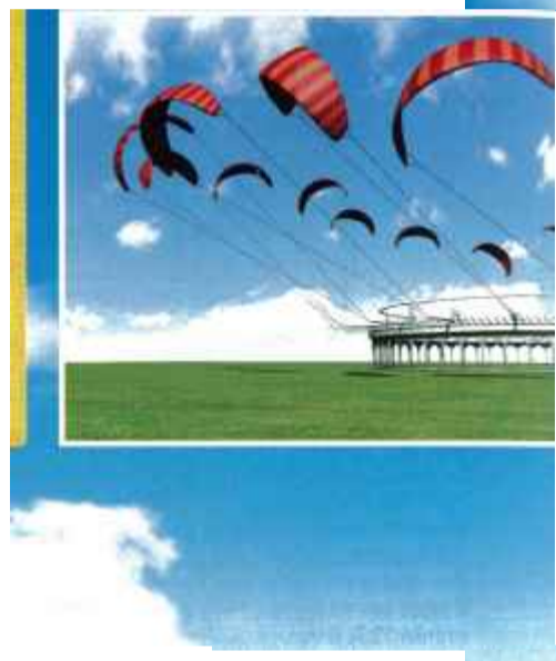
Impianto da 1GW (sottogli aquiloni fanno girare turbina larga 1,6 km).
